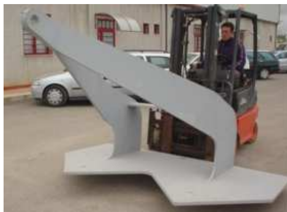
Figura 4. Ancla para fondos de arena, grava o fango
